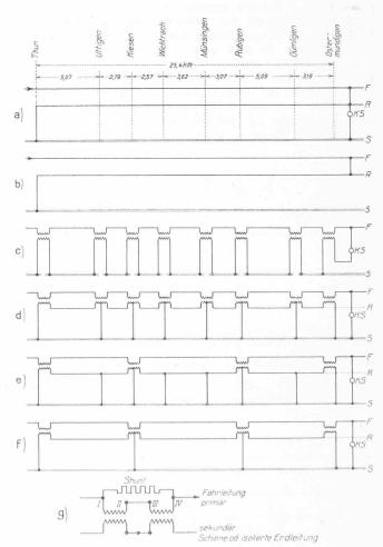
Schaltung der Saugtransformatoren bei den verschiedenen Versuchen.
