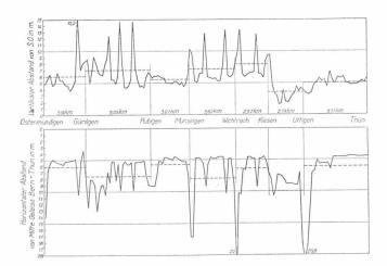
Abb. 8. Abstand des Messdrahtes vom Geleise links der Versuchstrecke.
