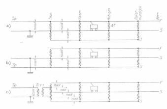
Abb. 2. Schaltmöglichkeiten der Leitungsanlagen der Strecke Bern-Thun bei Dreileitersystem mit Autotransformatoren.
