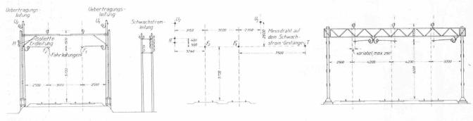
Abb. 5. Tragwerk auf der freien Strecke.
