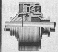
Benn-Kupplung, Typ NN, zur Verbindung zweier Wellen
