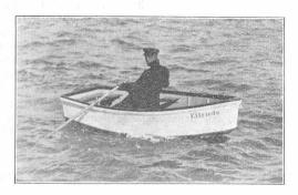
Abb. 1. Kleines Ruder- und Beiboot aus Duralumin.
