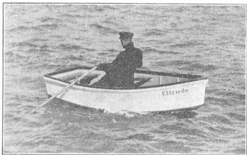
Abb. 1. Kleines Ruder- und Beiboot aus Duralumin.
