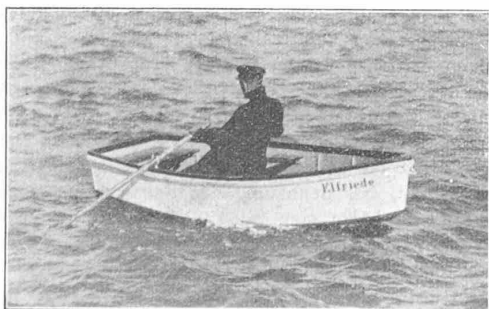
Abb. 1. Kleines Ruder- und Beiboot aus Duralumin.
