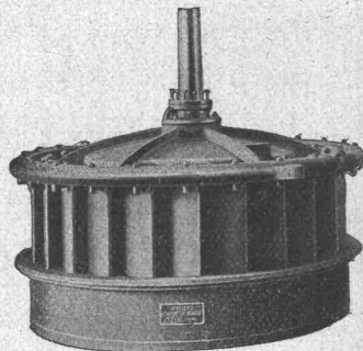
Turbine Francis à axe vertical et chambre d'eau ouverte.
