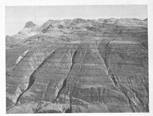
Abb. 16. Phototheodolith-Aufnahme mit autogrammetrisch eingezeichneten perspektivischen 50 m-Höhenkurven (Originalgrösse.)
