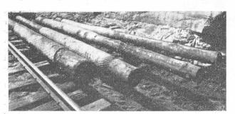
Abb. 15. Hölzerne Ramm-Pfähle mit teilweiser "Schutzverkleidung aus "Gunite", zwecks Erhärtung lagernd.
