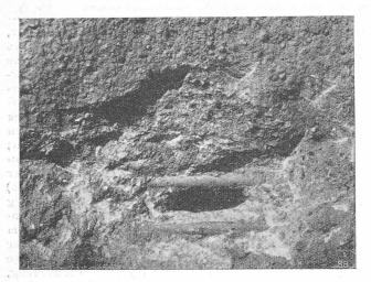
Abb. 14. Aus dem vollendeten "Gunite"-Ueberzug ausgespitztes Probeloch, zur Kenntlichmachung der Haftfestigkeit am Eisen.
