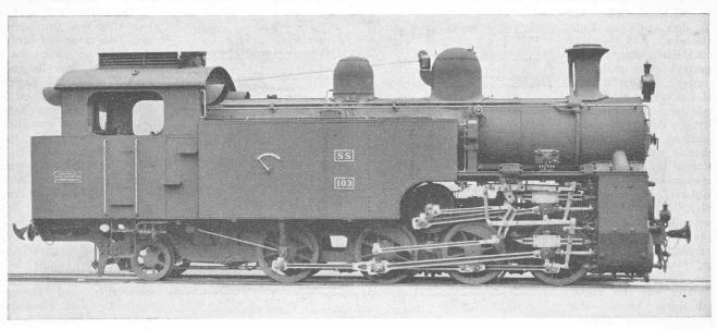
Abb. 2. 0-D-1-Nassdamof-Compound-Adhäsions- und Zahnrad-Lokomotive der Staatsbahn auf Sumatra nach "Bauart Winterthur",
