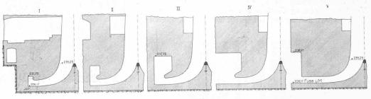
Abb. 20. Anordnung des Saugkrümmers der Turbinen nach L. F. Moody. — Masstab 1:300.
