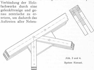
spannungen in den Knotenpunkten, vor allem jegliche Zugbeanspruchung senkrecht zur Holzfaser zu beseitigen. Aus dieser Ueberlegung heraus entstand eine Konstruktion, wie sie schematisch in Abbildung 5, in Anwendung in Abbildung 6 dargestellt ist. Wie ersichtlich, werden die Kräfte durch
