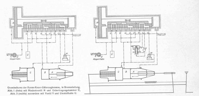
weise festhalten, denn in B kann über die Füllnut hinweg wohl der in der Bremsleitung herrschende Druck erreicht werden, aber kein höherer. Es fehlt daher von B aus die Kraft für eine Unterbrechung des Lösevorganges, bezw. zum Wiedervortreiben des Steuerkolbens.
