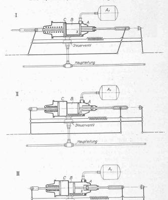
Abb. 5. Lage von Bremskolben und Gestänge: I. bei gelöster Bremse, II. bei kleiner Betriebs-Bremsstufe, III. bei Vollbremsung an beladenen Wagen.
