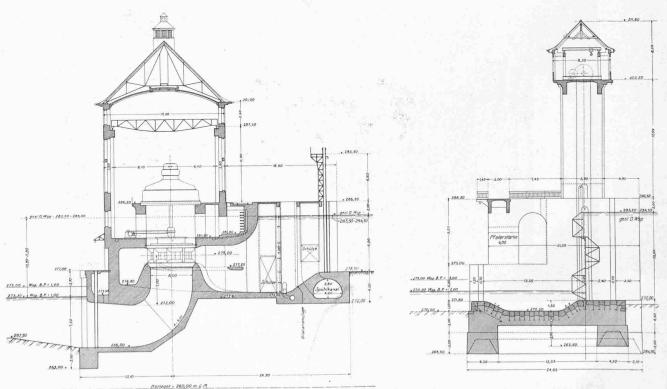
Aus Entwurf Nr. 6. - Abb. 12 und 13. Stauwehr und Turbinenanlage für das Kraftwerk Schwörstadt. - Masstab 1: 500.
