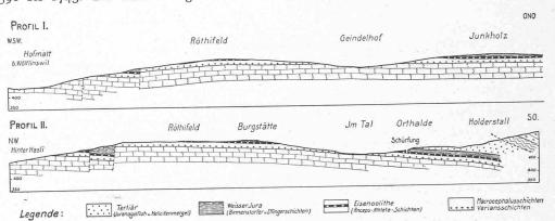
Abb. 2. Geologisches Profil des Fricktales. - Profil WSW-ONO (westl. Teil). - Profil II, NW-SO. - Masstab 1:15000.
