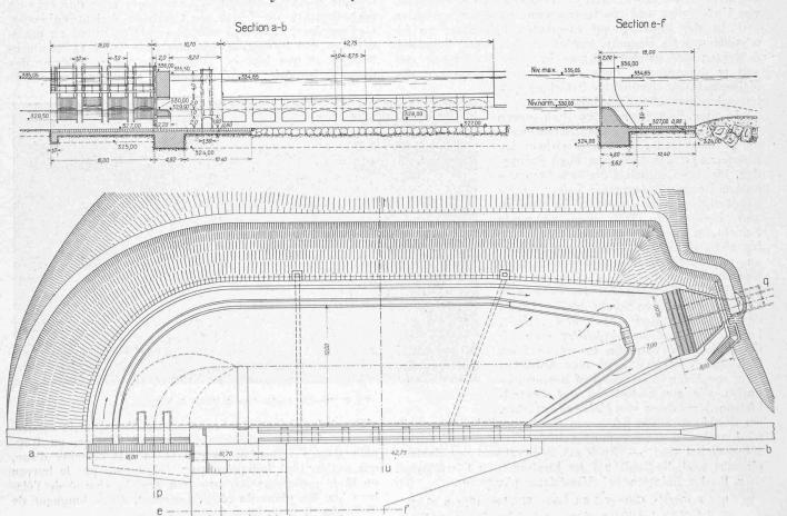
Fig. 8. Plan de la prise d'eau, du bassin de décantation et de l'entrée de la galerie, et sections du barrage. — Echelle 1:600.
