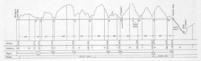
Fig. 5. Profil en long des installations de l'usine hydro-électrique du Guadiaro à Buitreras. - Echelle 1:40 000.
