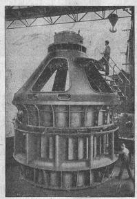
Einrad-Francis-Schnelläufer mit vertikaler Welle von 6000 HP Leistung bei 11 m Gefälle u. 52500 lit/sec Wasserkonsum, für das Kraftwerk Eglisau.
