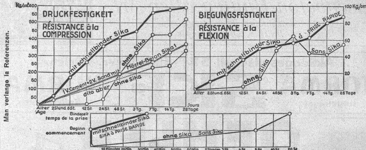
Die Probekörper wurden von der Anstalt selbst angefertigt. **Wasserdruck-Proben:** Bei Maximaldruck des Apparates (6 Atm.) blieben die Proben trocken. Mit schnellbindender SIKA kann während grossem Wasserdruck abgedichtet werden, selbst mittels Anstrichen.
