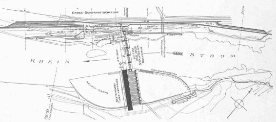
Abb. 7. Aus Entwurf Nr. 6. Richtig abgedrehte Gross-Schiffahrtschleuse beim Kraftwerk Laufenburg, - Masstab 1:5000.
