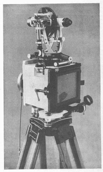
Abb. 10. Photo-Theodolit von Carl Zeiss (D = Distanzmess-Schraube).
