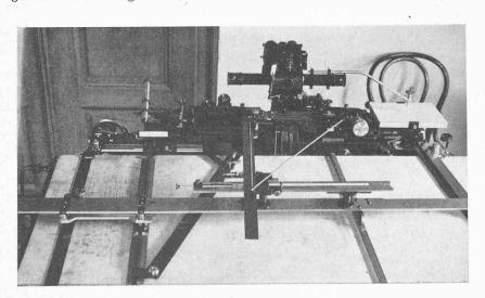
Abb. 14. Der stereoautogrammetrische Auftrageapparat nach Modell 1909.
