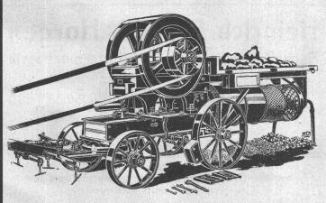
Fahrbarer Steinbrecher mit Sortierzylinder.
