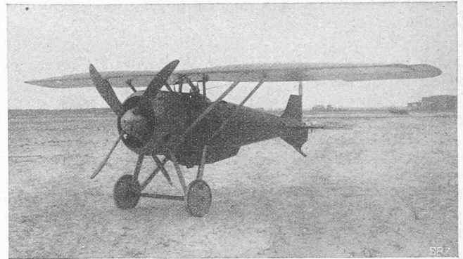
Abb. 2. Siemens-Schuckert-Eindecker-Jagdflugzeug, Typ D VI, 1917/18.
