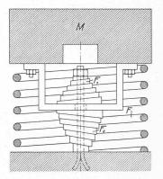
je mehr der Wagenkasten aus der Lage des statischen Gleichgewichts herauskommt, ohne dass ihre Nachgiebigkeit in der Mittellage stark vermindert wird. Neben hoher Stabilität hat somit diese Federung den Vorteil, aperiodisch zu sein, sodass im Fall periodisch wirkender Kräfte Resonanz-Erscheinungen vermieden werden. Im Juli 1920 vorgenommene Vergleichversuche, über die Ingenieur Leboucher im Dezemberheft der "Revue générale des Chemins de fer" sehr
