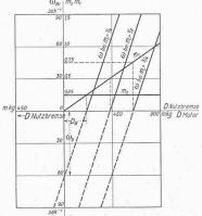
Abb. 11. Der nach System Oerlikon abgeänderte Einphasen-Seriemotor als neuartiger Motor und als Nutzbremse.
