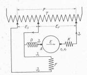
Abb. 9. Der Einphasen-Seriemotor zwecks Nutzbremsung nach System Oerlikon geschaltet, bei Verwendung einer Drosselspule D und getrennten Strömen Jr im Rotor und Js im Stator.
