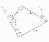
Abb. 10. Spannungsdiagramm des Ein-phasen-Seriemotors für die Schaltung nach System Oerlikon wie Abbil-dung 9, bei Wirkungsweise der Maschine als Motor.
