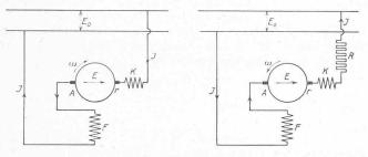
Abb. 7. Einphasen-Seriemotor mit Armatur A, Feld F, Kompensationswicklung K und Seriewiderstand r, als Motor (links) und als Gegenstrombremse (rechts) mit Bremswiderstand R.
