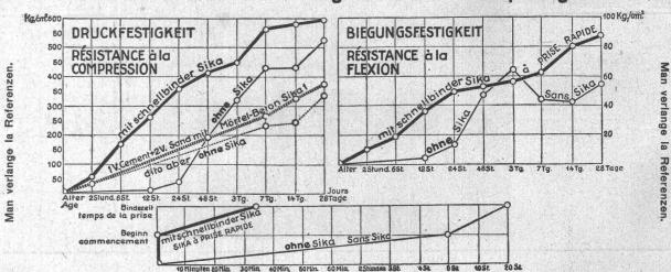
Die Probekörper wurden von der Anstalt selbst angefertigt. Wasserdruck-Proben: Bel Maximaldruck des Apparates (6 Atm.) blieben die Proben trocken. Mit schnellbindender SIKA kann während grossem Wasserdruck abgedichtet werden, selbst mittels Anstrichen.
