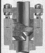
Für Schieber- u. Kolbenstangen, Ventil-Spindeln, Dampfturbinen, Pumpen etc. Für jedes Medium, Gas, Wasser, Dampf, Oel, Säuren etc. verwendbar.
