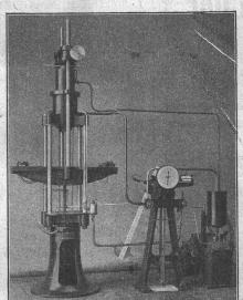
30 tons Zerreissmaschine
