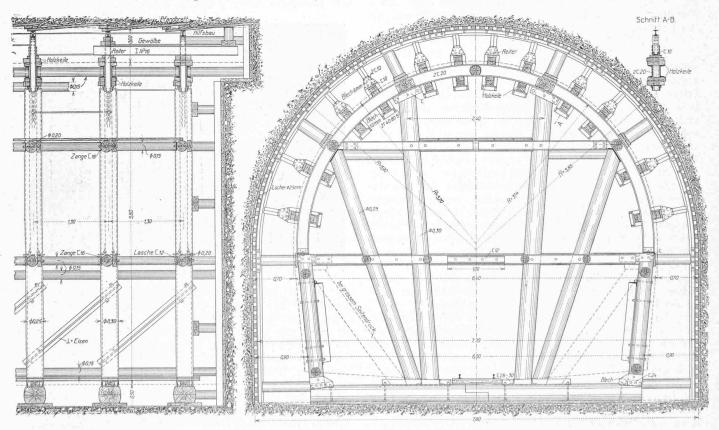
Abb. 1. Längs- und Querschnitt der Tunnelrüstung Alfred Kunz, D. R.P. a. - Masstab 1:60.
