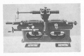
Abb. 6. Stereokomparator von Carl Zeiss, Jena.
