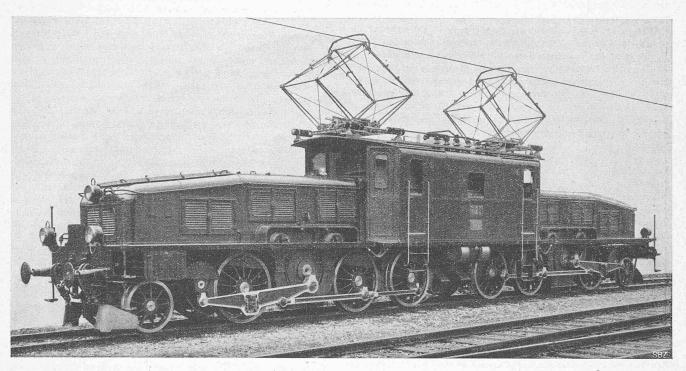
Elektrische Güterzuglokomotive für die S. B. B., gebaut von der Maschinenfabrik Oerlikon und der Schweiz. Lokomotivfabrik Winterthur (Text auf Seite 78).
