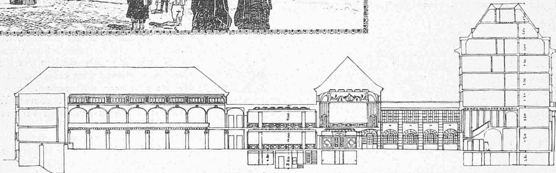
Längsschnitt durch Saalbau und Hotel. — Masstab 1:600.
