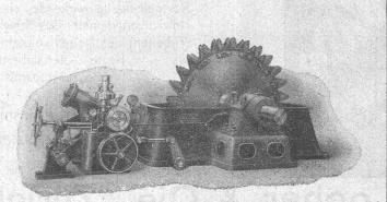
Turbine 4000 HP avec régulateur agissant sur le pointeau et le déflecteur
