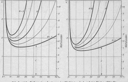
Abb. 8 und 9. Einfluss einer Aenderung des Wertes a=L:La auf den Wert c, gültig für  $f = 150 \ kg/t$ ,  $w = 2.5 \ kg/t$ ,  $a = 1 \ bis 3$ .  $f = 150 \, kg/t$ ,  $w = 5 \, kg/t$ ,  $a = 1 \, bis 3$ .
