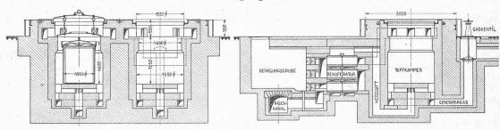
Abb. 6. Doppel-Topfglühofen mit Gasfeuerung und Rekuperator. - Masstab 1:100.
