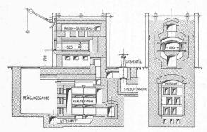
Abb. 5. Muffelofen mit Gasfeuerung und Rekuperator. — 1:100.
