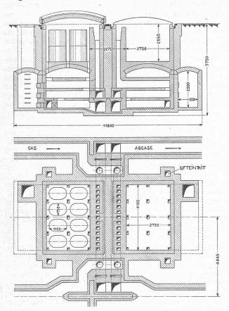
Abb. 7. Doppel-Temperofen mit Gasfeuerung und Rekuperatur. - 1:150.
