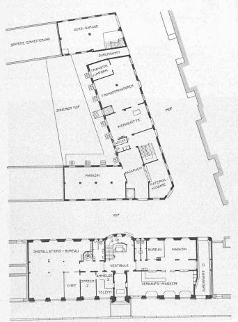
Abb. 1. Erdgeschoss-Grundriss des Haupt- und des Hintergebäudes. — 1:500.
