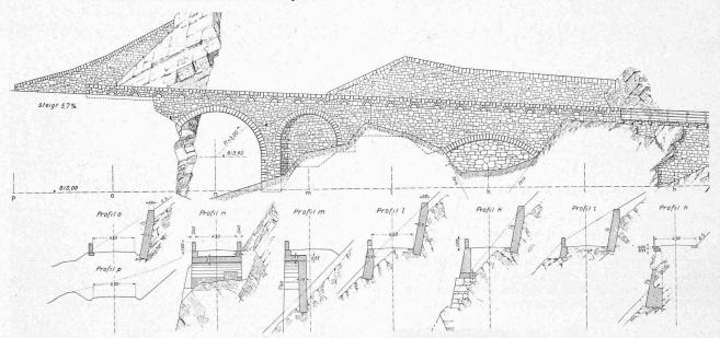
Abb. 11. Lehnenbau zwischen Km. 1,43 (rechts) und 1,51 (links) in der Lammschlucht. — Ansicht und Profile, Masstab 1:400.
