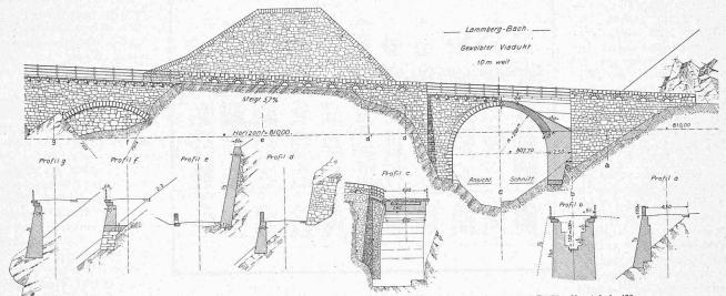
Abb. 10. Lehnenbau zwischen Km. 1,35 (rechts) und 1,43 (links) in der Lammschlucht. — Ansicht und Profile, Masstab 1:400.
