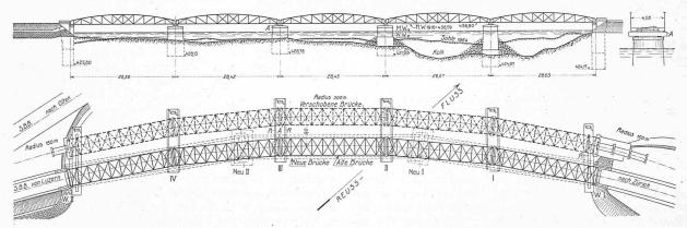
Abb. 1. Ansicht, Querschnitt und Grundriss der alten Brücke, Grundriss der verschobenen und der neuen Brücke. - Masstab 1:1000.
