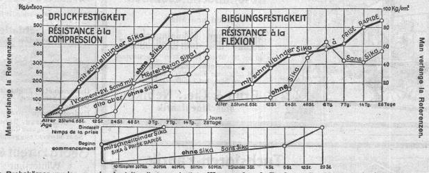
Die Probekörper wurden von der Anstalt selbst angefertigt. Wasserdruck-Proben: Bei Maximaldruck des Apparates (6 Atm.) bileben die Proben trocken. Mit schnellbindender SIKA kann während grossem Wasserdruck abgedichtet werden, selbst mittels Anstrichen.
