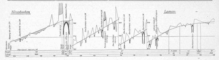
Abb. 4. Längenprofil der neuen Strasse vom Klusboden durch die Lammschlucht (bis Km. 1,9). Längen 1:8000, Höhen 1:800.
