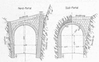
Abb. 9. Normalprofile für Tunnel und Portale. - Masstab 1:200.
