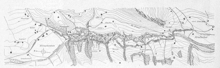
Abb. 3. Lageplan der alten und der neuen Strasse vom Klusboden bis Krutacher (Korrektions-Strecke 4). — Masstab 1:15000.
