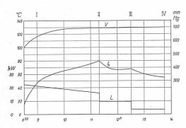
Abb. 9. Verlauf von Energieverbrauch und Temperatur bei der Heissdampf-Trocknung von Kohl.
