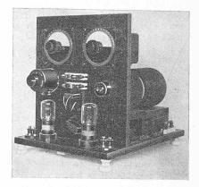
Abb. 2. Hochfrequenz-Empfänger für Mehrfach-Telephonie und Telegraphie auf Leitungen.
