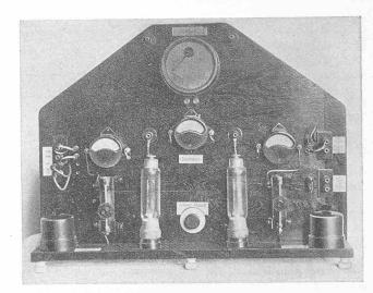
Abb. 1. Hochfrequenz-Sender für Mehrfach-Telegraphie u. Telephonie auf Leitungen.
