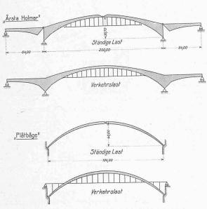
Abb. 14. Wirkungsweisen für ständige und für Verkehrs-Lasten.
