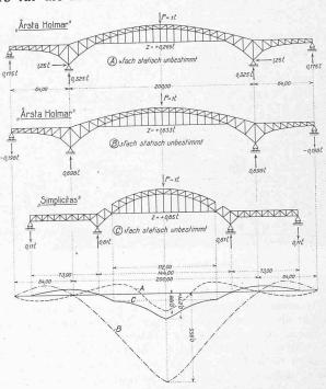
Abb. 15. Einflusslinien der lotrechten Scheitelsenkungen unter  $P=1\ t$ für die Fälle A, B und C. —  $25 \, mm$  der Zeichnung  $= 1 \, mm$  Durchbiegung.
