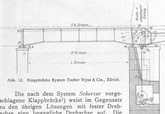
schlagene Klappbrücke1) weist im Gegensatz zu den übrigen Lösungen mit fester Drehachse eine bewegliche Drehachse auf. Die mit einem Zahnkranz-Segment verbundene
