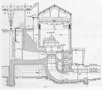
Abb. 7. Schnitt durch das Maschinenhaus. - Masstab 1:500.
