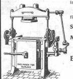
Hydraul. Abhebeformmaschine mit oberer Pressung und Abhebung von Hand.
