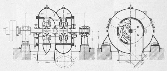
Abb. 6. Längs- und Querschnitt durch die Sulzersche Hochdruckpumpe für 4500 PS, 735 Uml/min.
