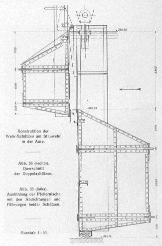
keit der unteren Schütze zu sichern und ein Versanden derselben zu verhindern. Die Stellung V ist eine Ausnahmestellung. Die obere Schütze ist für sich über den Stau gehoben, während die untere Schütze geschlossen bleibt, was bei Revisionen der erstern vorkommen kann. Die Höchstlage der Schützen bei Stellung III und IV ist durch einen automatischen Endausschalter festgelegt.
