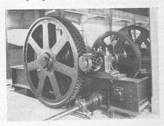
Abb. 36. Antrieb der Kettenachsen für die Gallschen Ketten.
