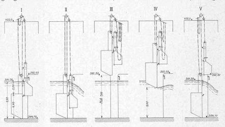
Abb. 29. Schematische Darstellung der verschiedenen Doppelschützen-Stellungen. - 1:300.
