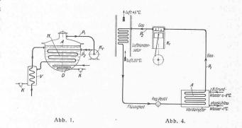
vielleicht mit o<sup>o</sup> C zu und wird durch die Kompression auf eine Temperatur gebracht, die geeignet ist, im Kondensator Luft, beispielsweise auf 45° C zu erwärmen, sodass damit eine Luftheizung betrieben werden kann. Es ist dabei zu beachten, dass bei trockener Kompression das Medium den Kompressor mit ziemlich starker Ueberhitzung und dementsprechend hoher Temperatur verlässt, sodass es gewünschten Falls möglich ist, Luft oder Wasser auf eine
