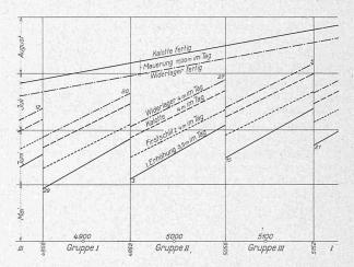
Abb. 3. Ausschnitt aus dem Bauprogramm des Simplontunnels II.
