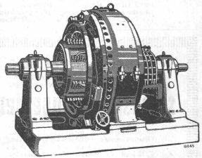
Einanker-Umformer für 1000 kW. Drehzahl 750, 500 Volt, 2000 Amp.
