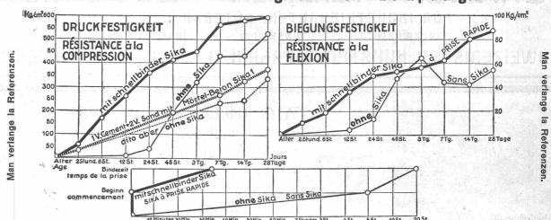
Die Probekörper wurden von der Anstalt selbst angefertigt. Wasserdrack-Proben: Bei Maximaldruck des Apparates (6 Atm.) blieben die Proben trocken. Mit schnellbindender SIKA kann während grossem Wasserdruck abgedichtet werden, selbst mittels Anstrichen.
