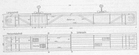
Abb. 1 und 2. Schnitte und Draufsicht der Eisenbeton-Schwelle. - Masstab 1:12.
