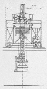
Abb. 3. Seitenansicht der Laufkatze mit Hubvorrichtung. Masstab 1:150.
