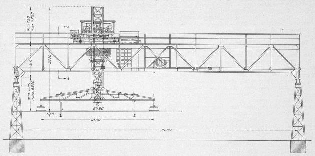
Abb. 2. Laufkran mit Lasthebemagneten zum Transport von 20 m langen Walzeisen. — Gebaut von der Maschinenfabrik Oerlikon. — Masstab 1:150.
