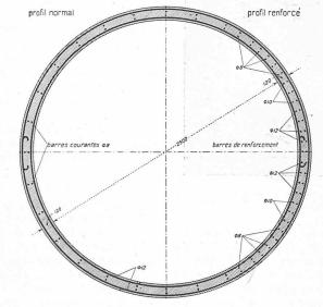
Fig. 2. Coupe en travers, échelle 1:35; à gauche profil normal, à droite profil renforcé pour les courbes.
